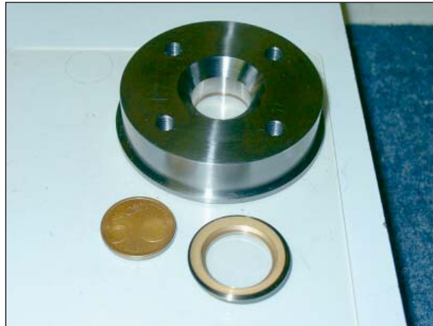
Saphirfenster ( \varnothing 18, t= 4 mm) für chemische Prozessüberwachung
